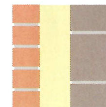
Figuur 1: bestaande spouwmuur met ingeblazen isolatie
